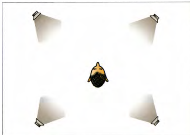
A kvadrofón (fent) és a Dolby-sztereó hangszórórendszer (lent) A „C” hangszóró előtti csík a filmvászonra (képernyőre) utal, a hátsó hangszórókat összekötő pontozott vonal pedig azt jelzi, hogy azok lényegében azonos jelet sugároznak.
