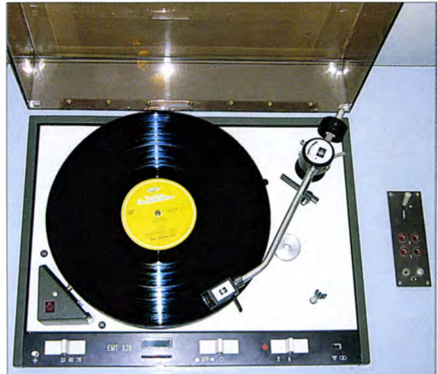
EMT gyártmányú, három fordulatszámú stúdiólemezejátszó. Minden „extrát” tartalmaz: a tűnyomás és a fordulatszám finombeállítása, a hangszedő automatikus ráhelyezése a lemezre, anti-scating, a lemez helyi megvilágítása a tű ráhelyezésekor.
